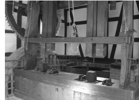
Die Keilpresse der Mühle, links Kamm- und Partnerrad, rechts Press-Stempel und bestückte Pressgrube
