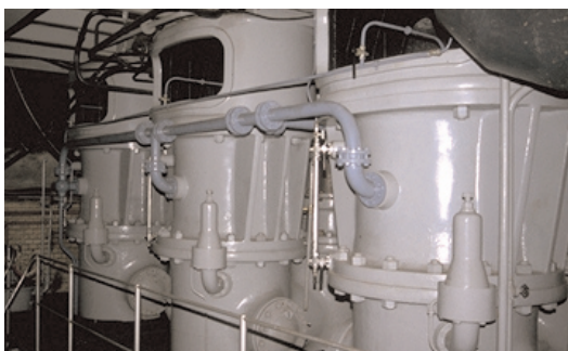
Die dreifache Plungerpumpe unter der Dampfmaschine
