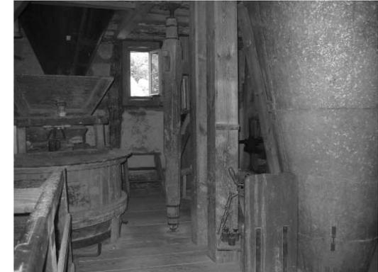
Mahlboden der Brücknermühle, links der Steinmahlgang, rechts der Speicher vor dem Walzenstuhl
